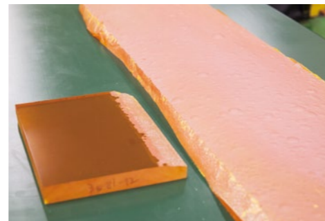
Zinc selenium (ZnSe) crystal ingot
